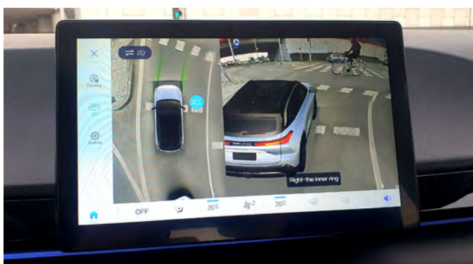
System kamer monitorujących otoczenie pojazdu 360°
